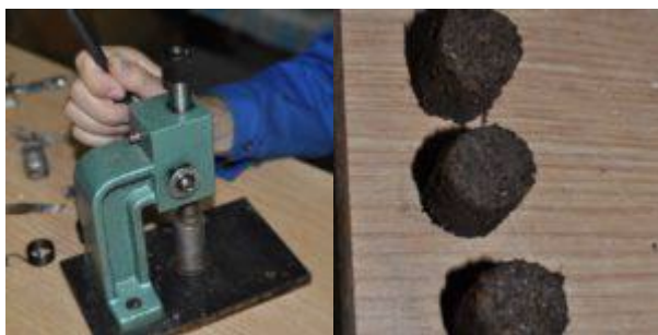
Рис. 4 . Лабораторный брикетировочный пресс для производства гранул
