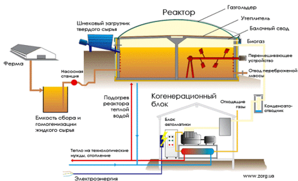
Рис. 2. Общая схема производства биогаза
