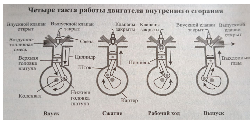
Рисунок 1 Принцип работы четырехтактного двигателя
