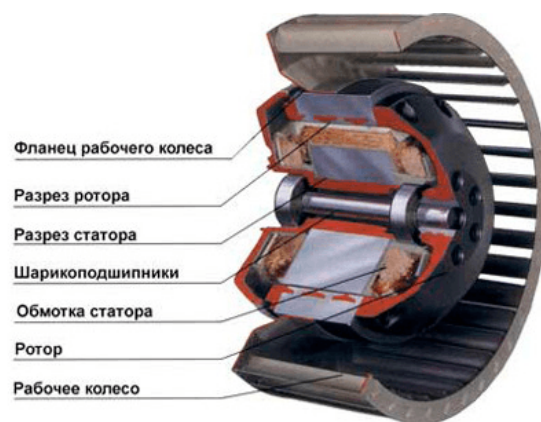
Рисунок 8 Устройство электродвигателя в разрезе
