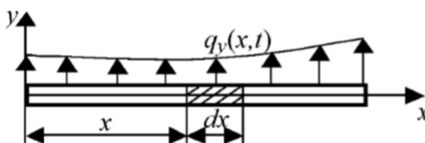
Рисунок 1.1 – Балка на упругом основании
