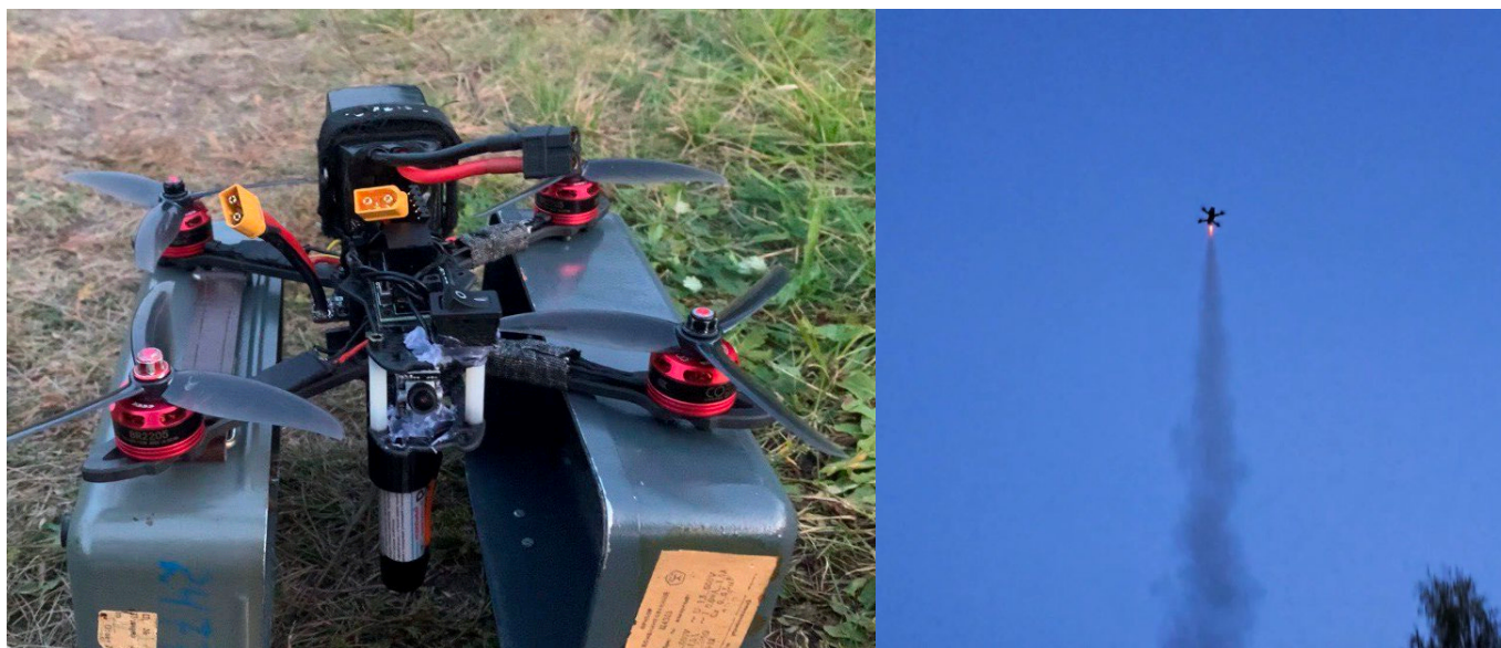
Рис. 3.3. Модель квадрокоптера в сборе с ракетным двигателем
