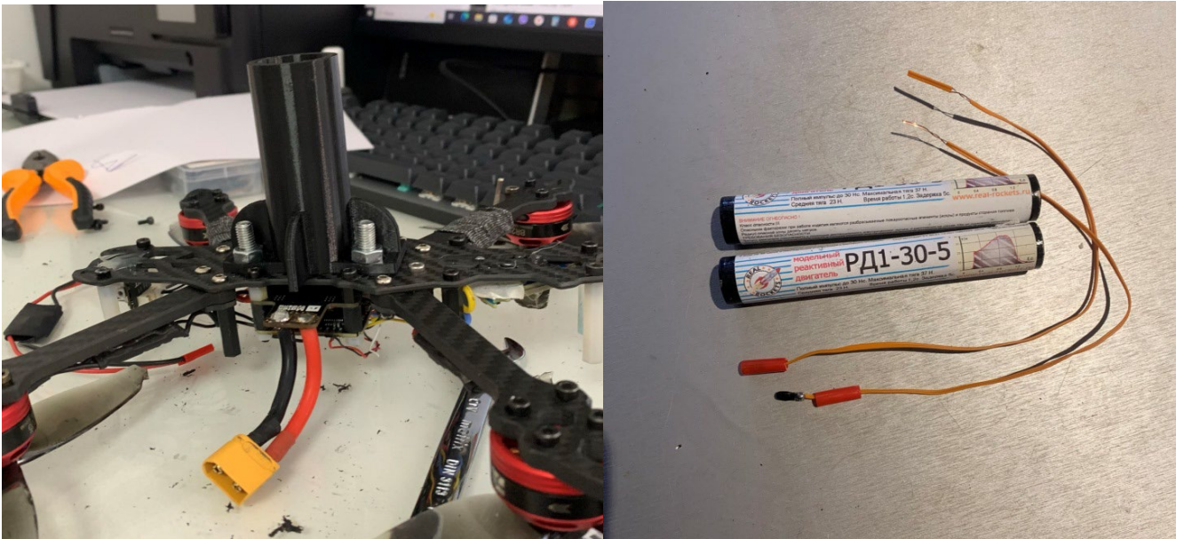
Рис. 3.1. Смонтированный держатель РД, модельные реактивные двигатели и электрические воспламенители
