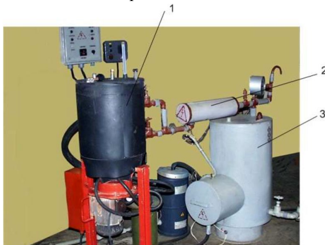
Рисунок 8 – Экспериментальная установка для влаготепловой обработки комбикорма: 1 – смеситель-кондиционер порционного действия; 2 – электропароперегреватель; 3 – электрический парогенератор
